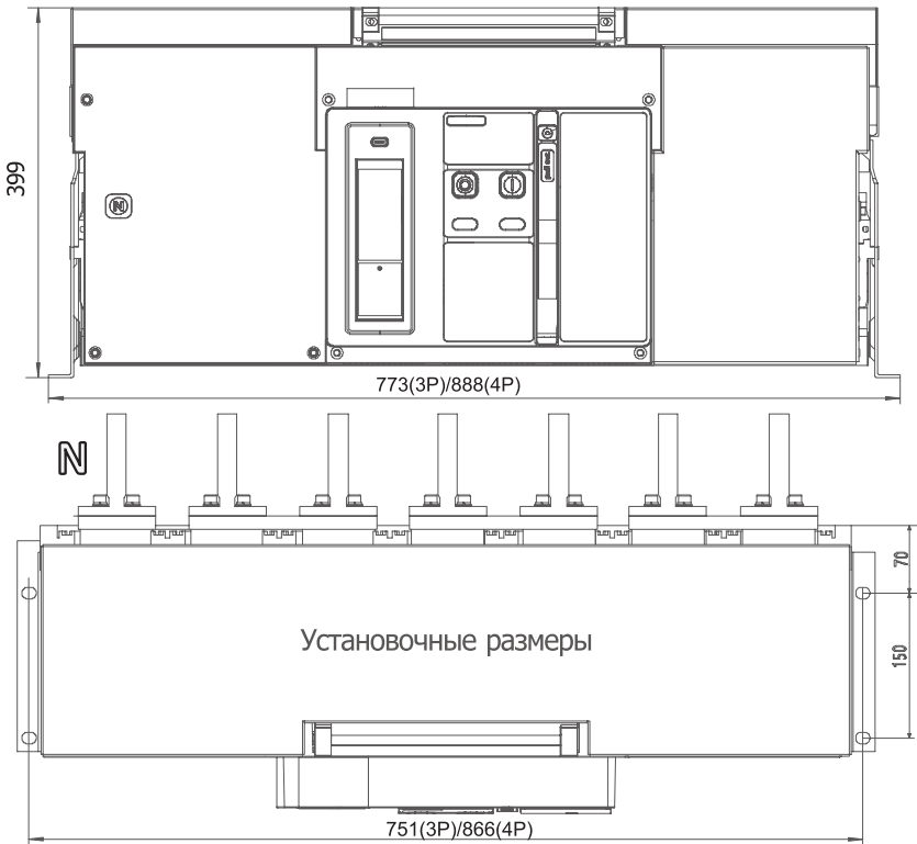
4000А, 5000А Горизонтальное подключение
